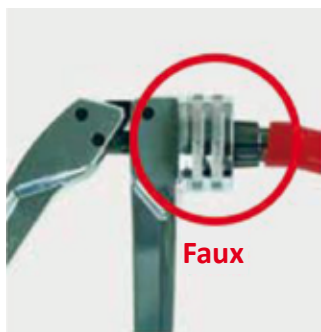
Évasement sous contrainte de flexion
