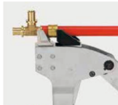
Procédé manuel de glissement de bague avec pince à levier articulé.
