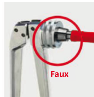
Tuyau pas entièrement glissé sur le mandrin d'évasement
